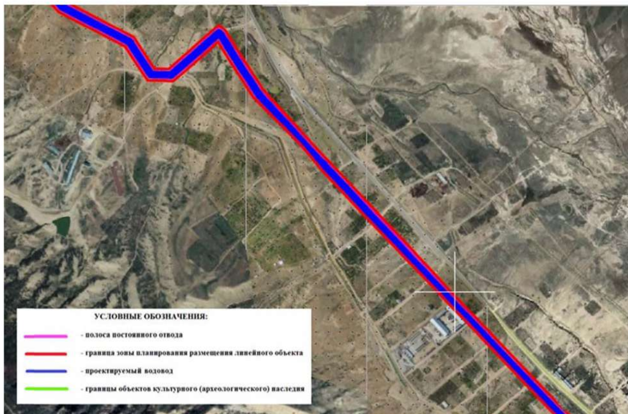
Рис. 19а. Республика Дагестан. «Проектирование и строительство магистрального водовода Чиркей-Махачкала-Каспийск, Республика Дагестан». Утвержденная полоса землеотвода, 2023 г.
