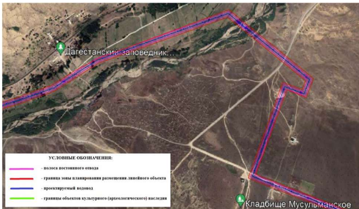
Рис. 82а. Республика Дагестан. «Проектирование и строительство магистрального водовода Чиркей-Махачкала-Каспийск, Республика Дагестан». Утвержденная полоса землеотвода, 2023 г.
