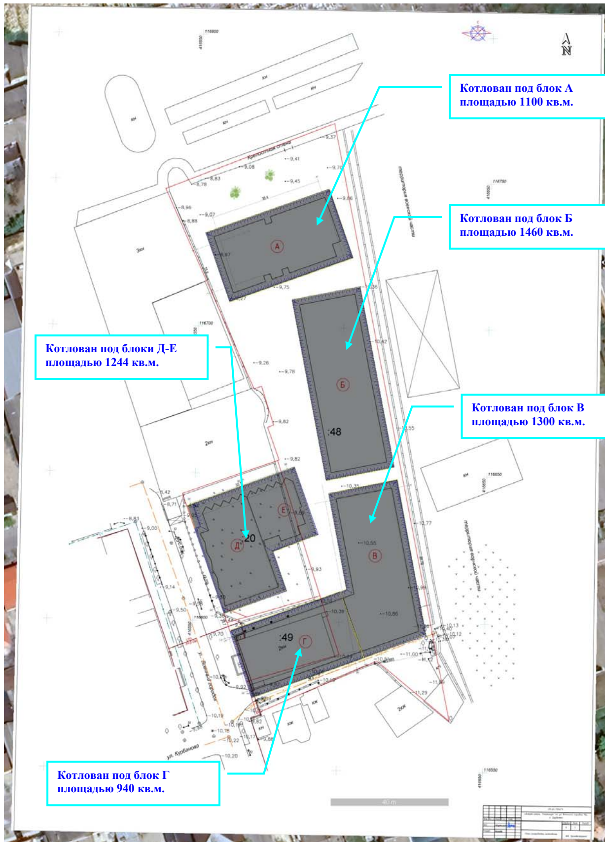
Илл.115. Показание планируемых работ по рытью котлованов для устройств фундаментов под новые планируемые строения гостиничного комплекса.
