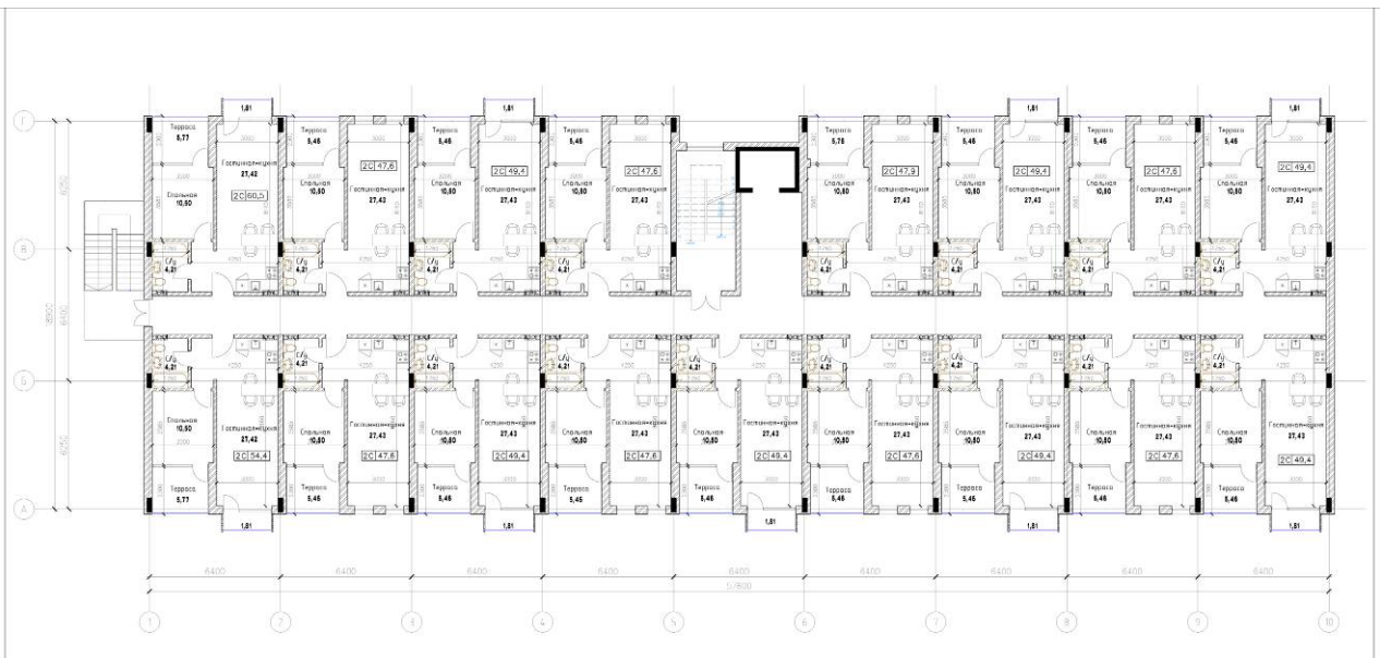
Илл.61. Блок Б. План 3-го этажа.
