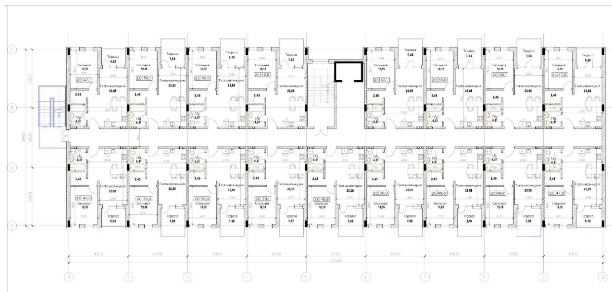
Илл.60. Блок Б. План 2-го этажа.
