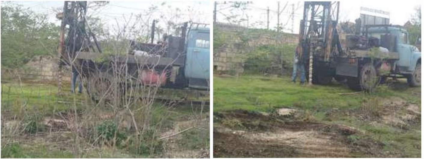
Фото 1,2. Рекогносцировочное обследование участка. Взятие грунтовых проб на исследуемом участке методом вращательно-механического бурения
