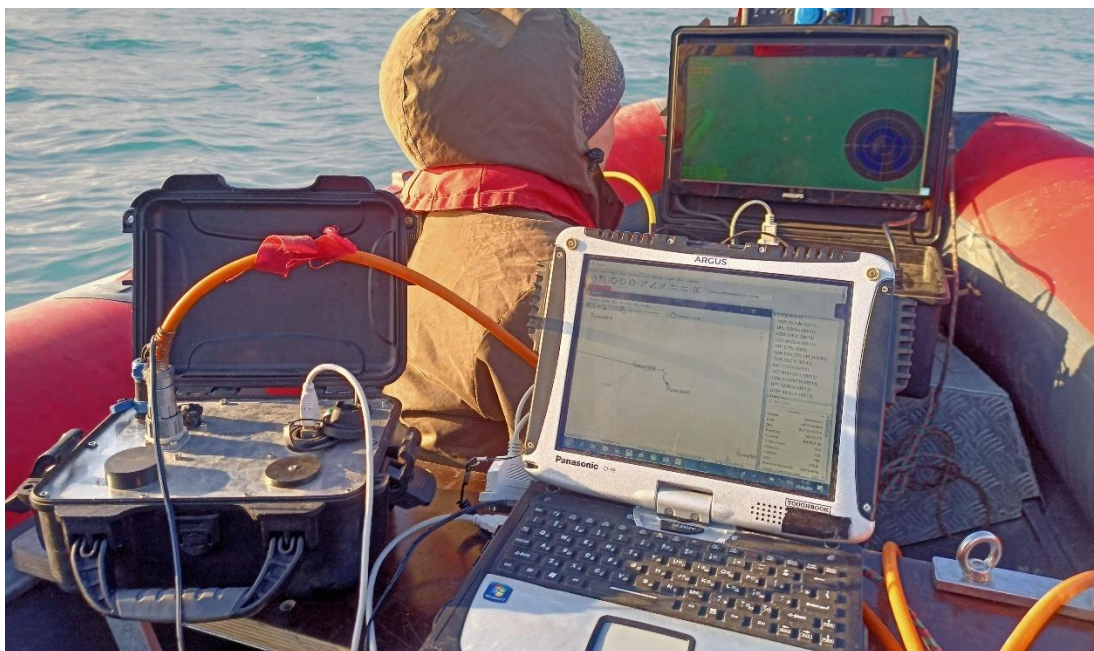
Рис. 60. Обследование целей с помощью ТНПА 1
