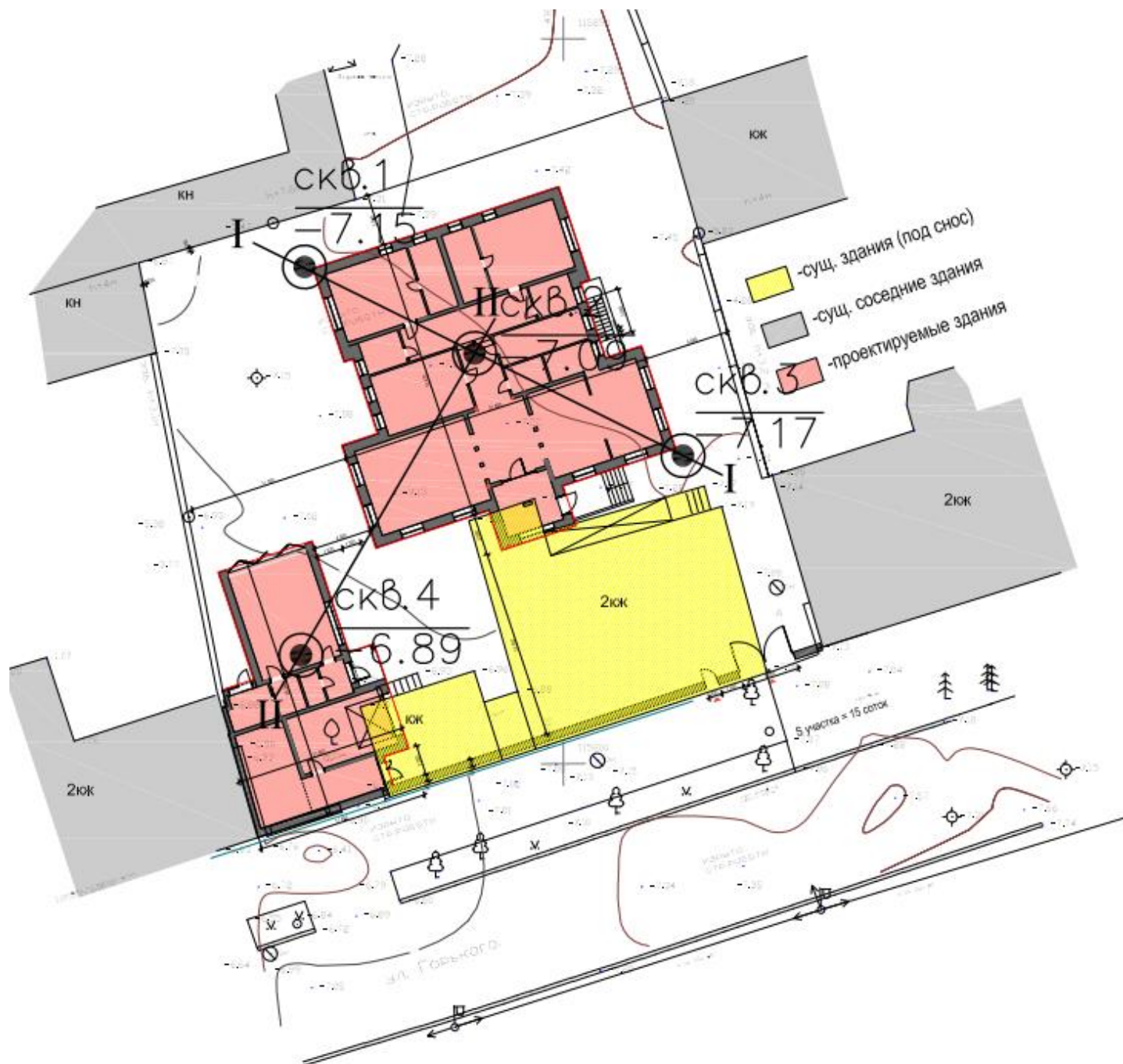
Рис. 1. Проектируемые здания по отношению к существующим объектам капитального строительства на рассматриваемом участке
