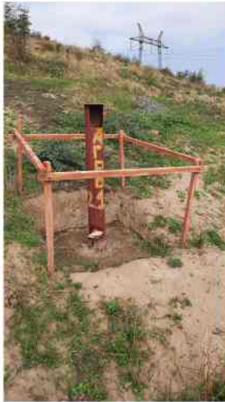
Рис. 18. ВОКН "Ансамбль памятников "Зидьян-Казмаляр". Реперный пункт строителей автодороги (МГРО 21), принятый за нулевую отметку ( P \pm 0 )
