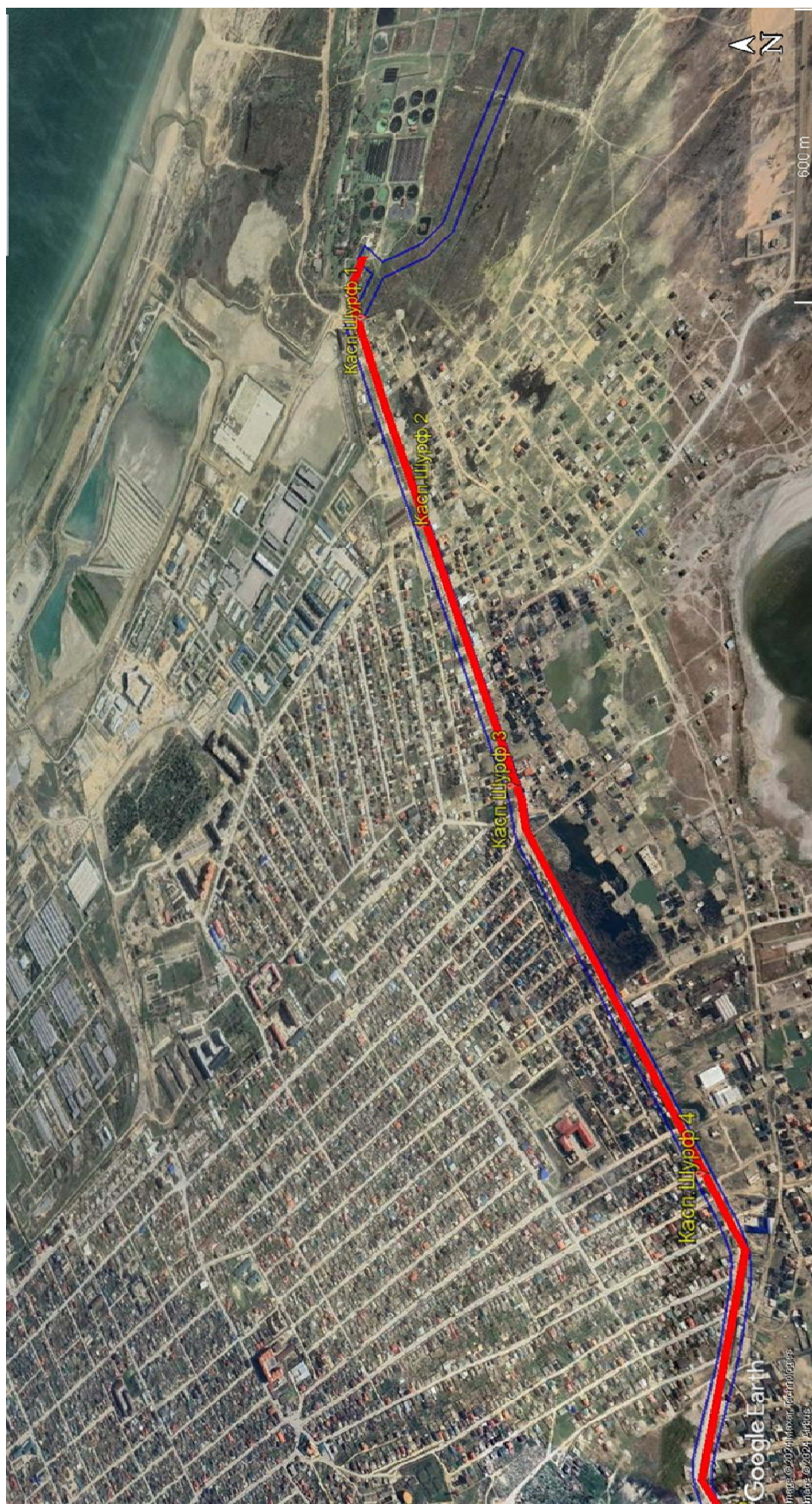
Рис. 63. Республика Дагестан. Объект «Проектирование и строительство напорной нитки D 1400 мм от ГКНС-6 г. Махачкалы до канализационных очистных сооружений г. Каспийска протяжённостью 16,0 км и производительностью 300 тыс. куб. м. в сутки». Шурф 1-4.
