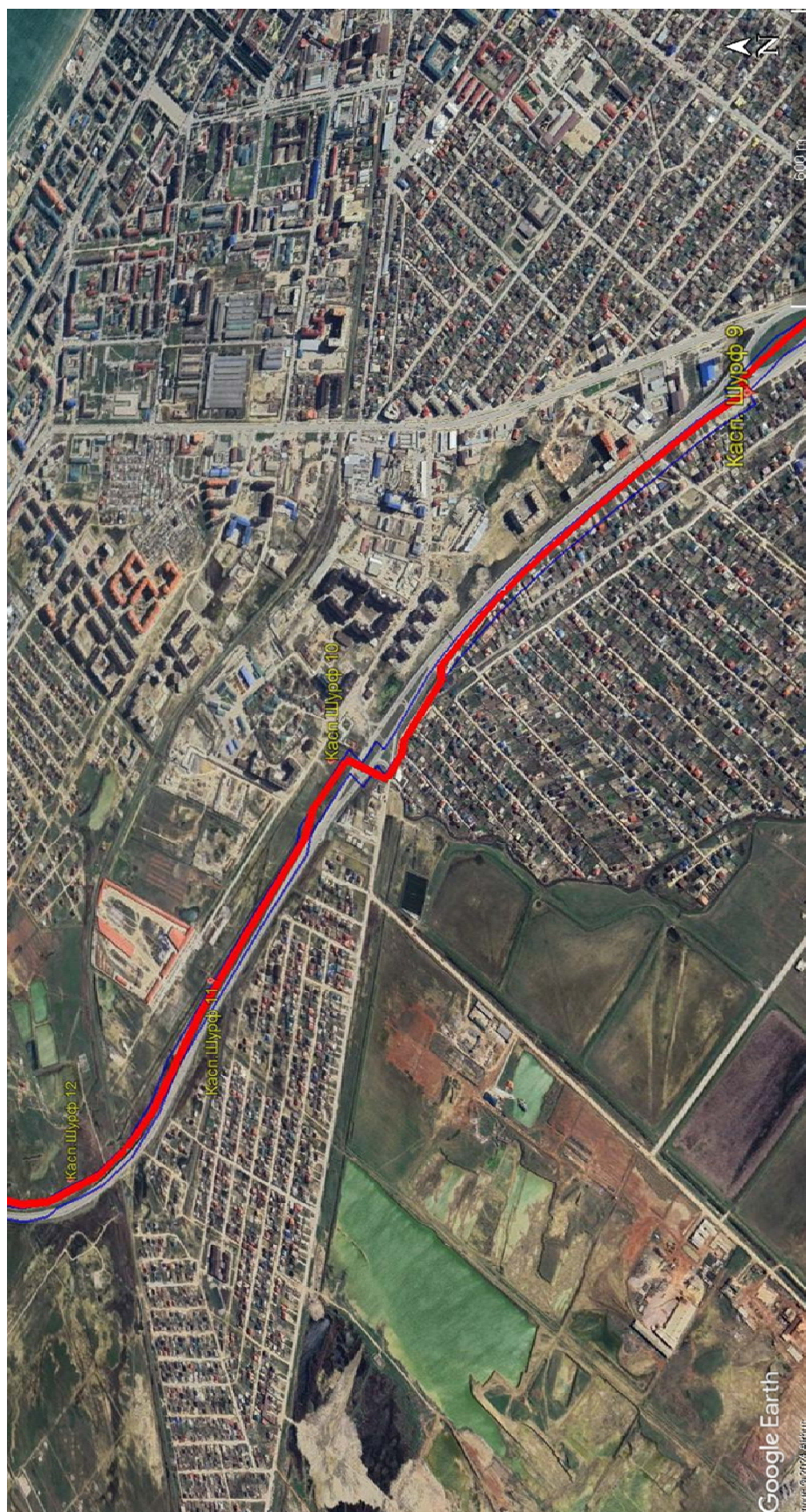
Рис. 109. Республика Дагестан. Объект «Проектирование и строительство напорной нитки D 1400 мм от ГКНС-6 г. Махачкалы до канализационных очистных сооружений г. Каспийска протяжённостью 16,0 км и производительностью 300 тыс. куб. м. в сутки». Шурф 9-12.
