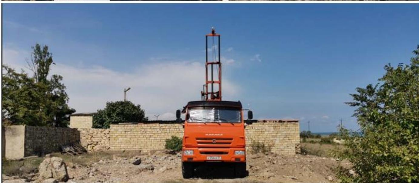
*Фото 1,2. Рекогносцировочное обследование участка. Взятие грунтовых проб на исследуемом участке методом вращательно-механического бурения*
