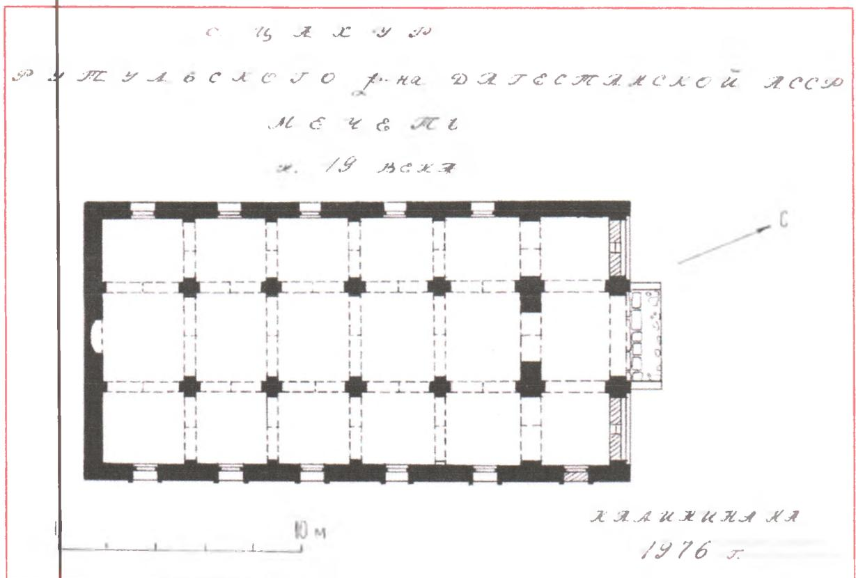
Рис.3. План здания Джума-мечети, с отображением 14 опорных крещатых столбов (2 встроены в стены южного фасада).
